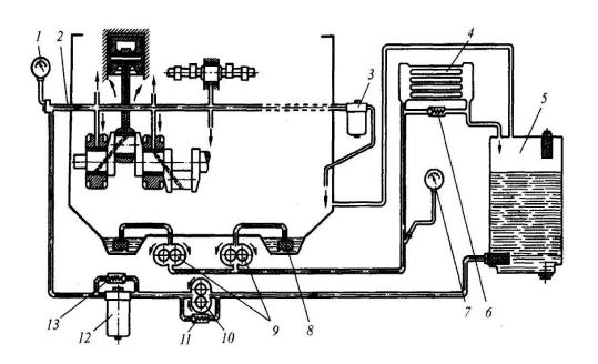
Рис. 2. Смазочная система с «сухим» картером: 1 — манометр; 2 — главная масляная магистраль; 3 — фильтр тонкой очистки; 4 — масляный радиатор; 5 — масляный бак; 6 — перепускной клапан радиатора; 7 — указатель температуры масла; 8 — маслозаборник; 9 — откачивающие секции масляного насоса; 10 — нагнетающая секция масляного насоса; 11 — редукционный клапан; 12 — фильтр грубой очистки; 13 — перепускной клапан фильтра; 14 — картер двигателя
