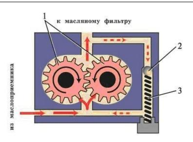
Рис. 3. Схема работы масляного насоса: 1 - шестерни масляного насоса; 2 - редукционный клапан; 3 - пружина
