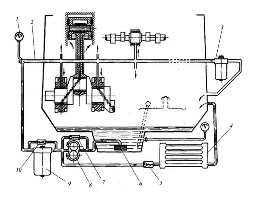
Рис. 1. Смазочная система с «мокрым» картером: 1 — манометр; 2— главная масляная магистраль; 3 — фильтр тонкой очистки; 4 — масляный радиатор; 5 — предохранительный клапан радиатора; 6 — маслозаборник; 7 — редукционный клапан; 8 — масляный насос; 9 — фильтр грубой очистки; 10 — перепускной клапан фильтра.
